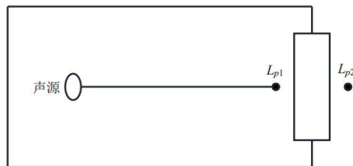
图 4-1 室内声源等效为室外声源图例
