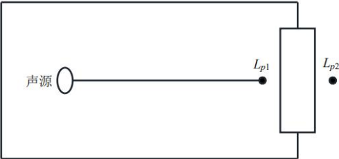
图 3 室内声源等效为室外声源图例
